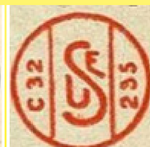
1957 г. Маркировка USE, отпечатанная с номером стандарта (C32) и идентификационным номером производителя (295)
